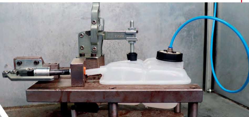
ESSAI BARRE: test de pression d'air et d'eau
