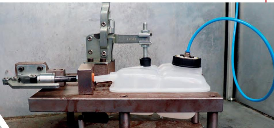
Prueba de presión hidrostática y neumática.
