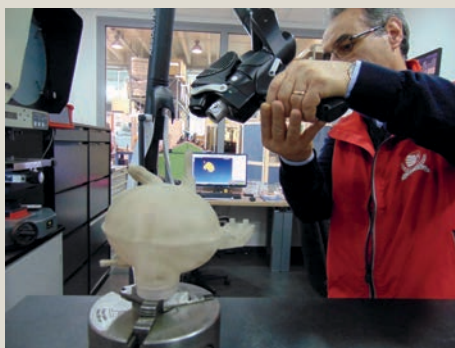
Il braccio di misura portatile di Hexagon è totalmente integrato con VISI Reverse per realizzare la scansione di particolari, la gestione nuvola di punti e la ricostruzione modello
